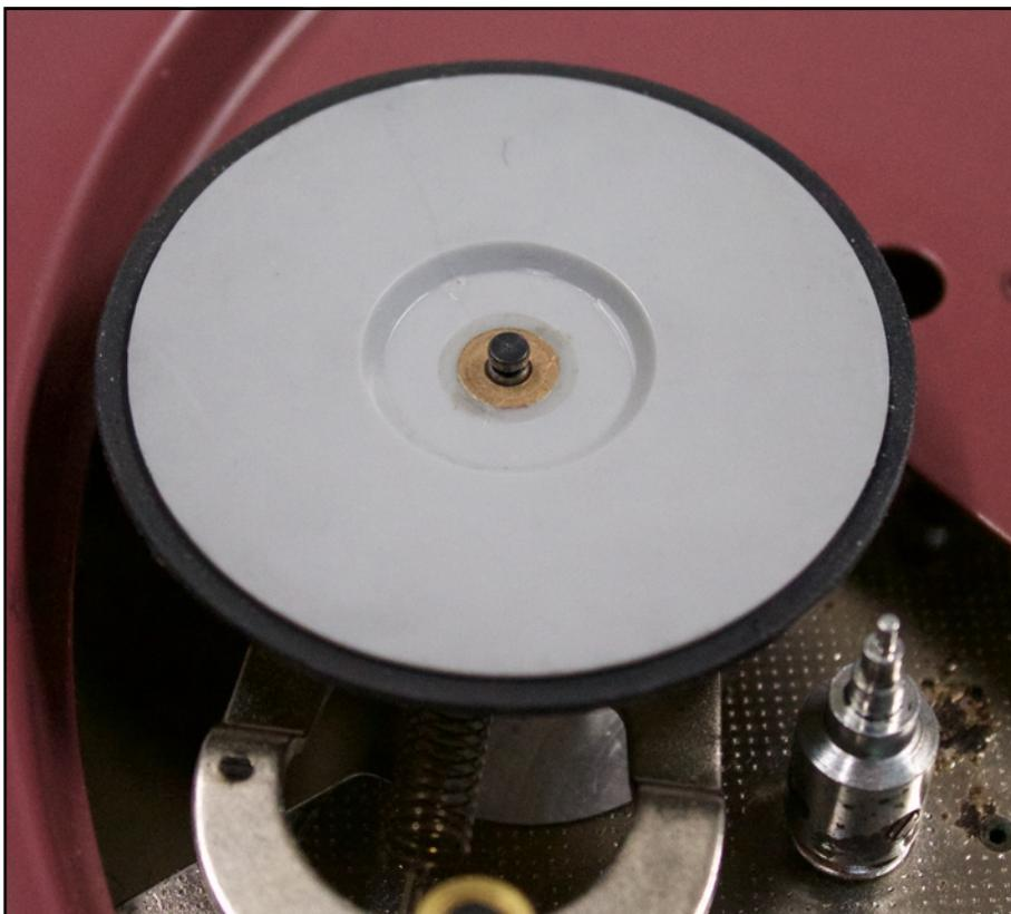
Zwischenrad auf die leicht geölte Achse setzen.
