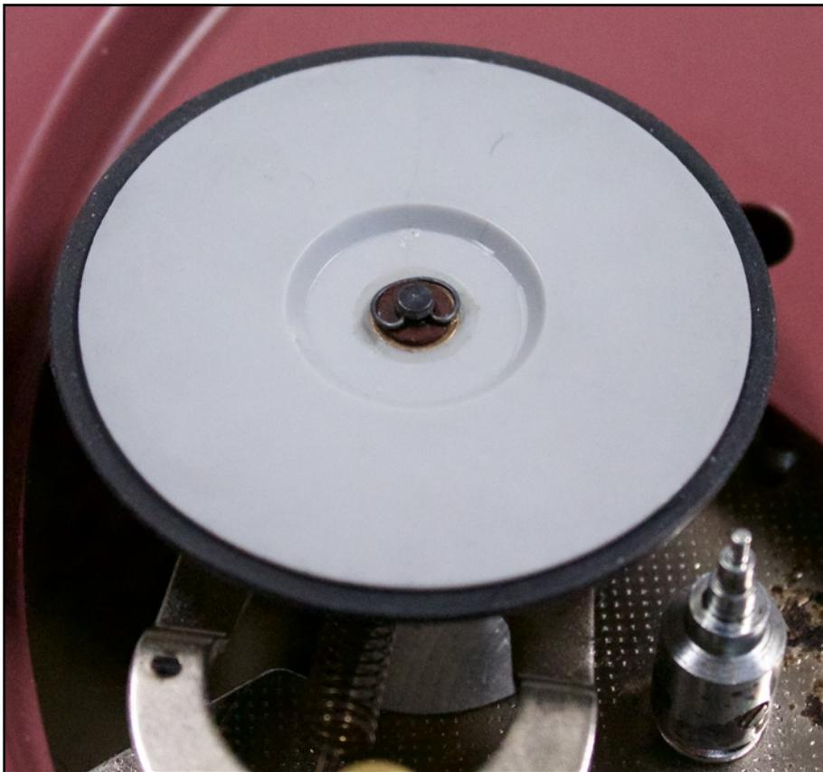
Clip montieren, Plattenteller mit Gummimatte montieren und mit Sicherungsclip fixieren- Fertig!
