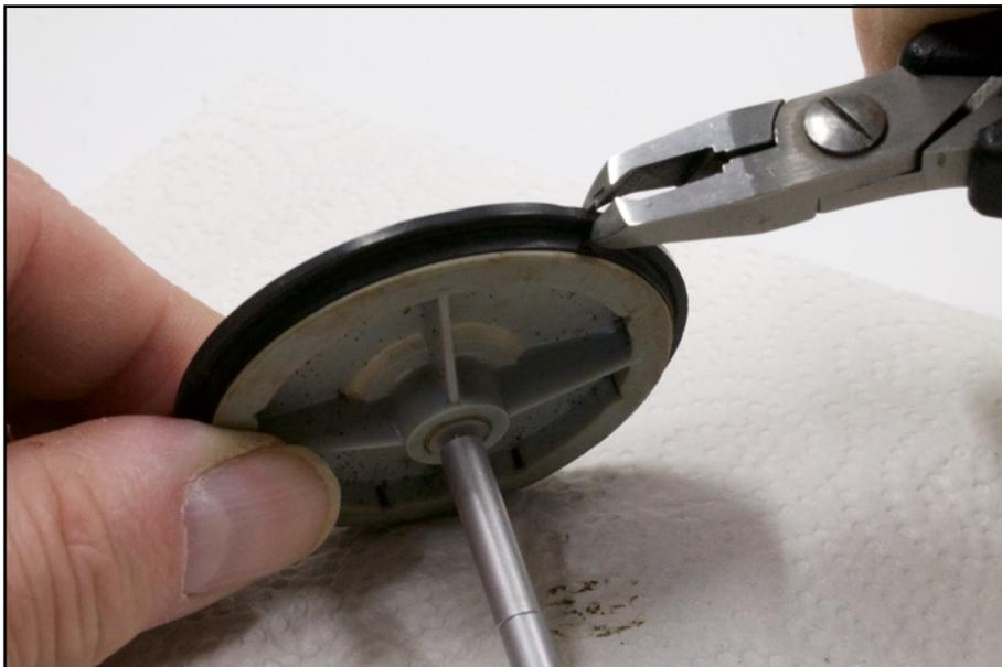
Den alten Zwischenradgummi mit Seitenschneider durchtrennen, der harte Gummi bricht...
