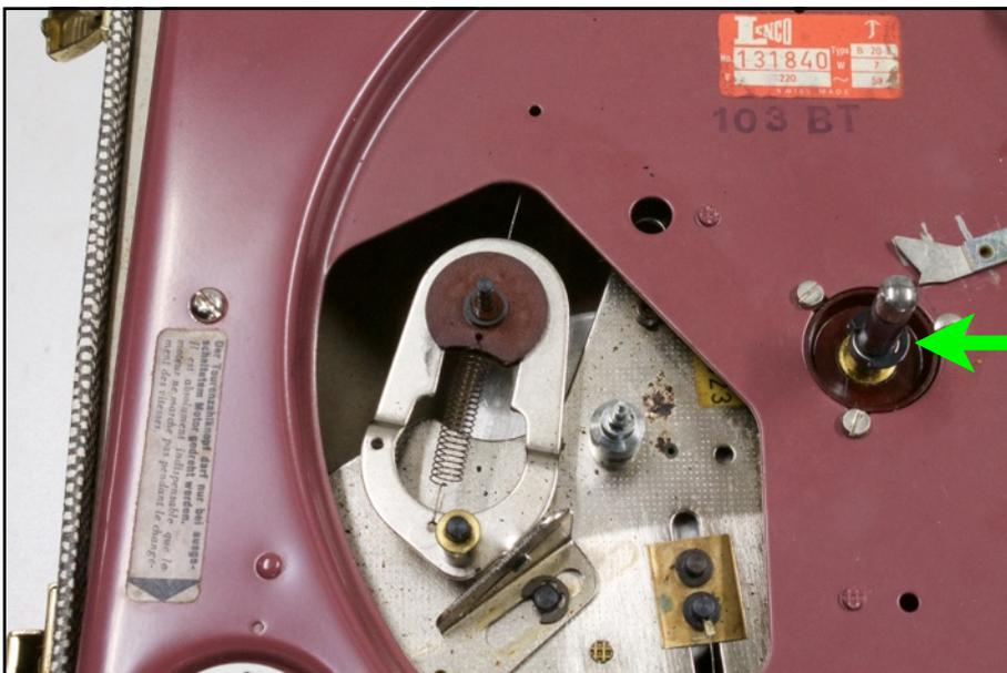
Dann Zwischenrad entfernen und Achse reinigen.
